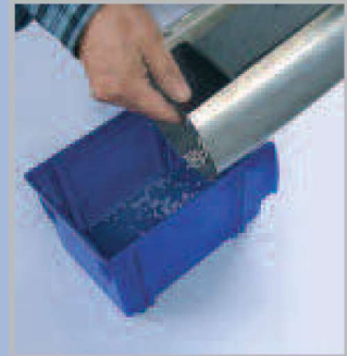
.. and then pour off the granules.
